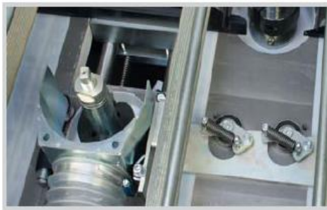
Регулиране на прибавката за профилиране с левия регулируем, вертикален фрезови шпиндел
