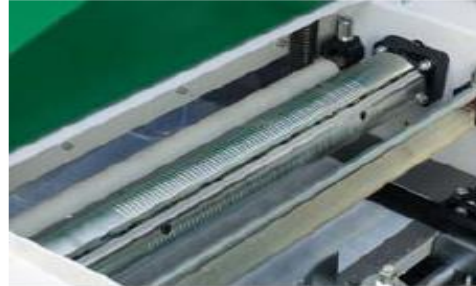
Горен, комбиниран ножов вал за калиброване и профилиране
