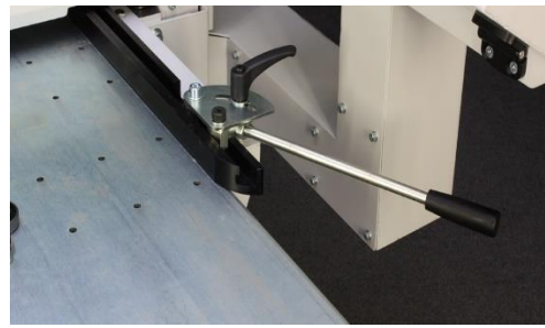
Регулиране на прибавката за калиброване/профилиране с десния вертикален, фрезови шпиндел
