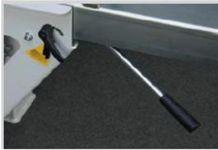
Лесно регулирането на дълбочината на калиброване с долния ножов вал от 0 до 10 мм
